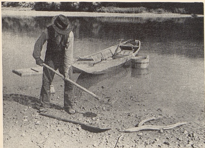
Lapátpróba: a fővenyt az „aranynéző” égetett falapátra rakja
